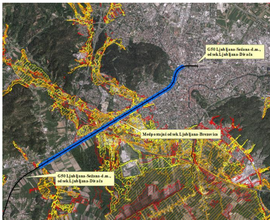
Slika 8: Karta poplavne nevarnosti za železniško progo Ljubljana-Brezovica (vir: Geoportal ARSO)
